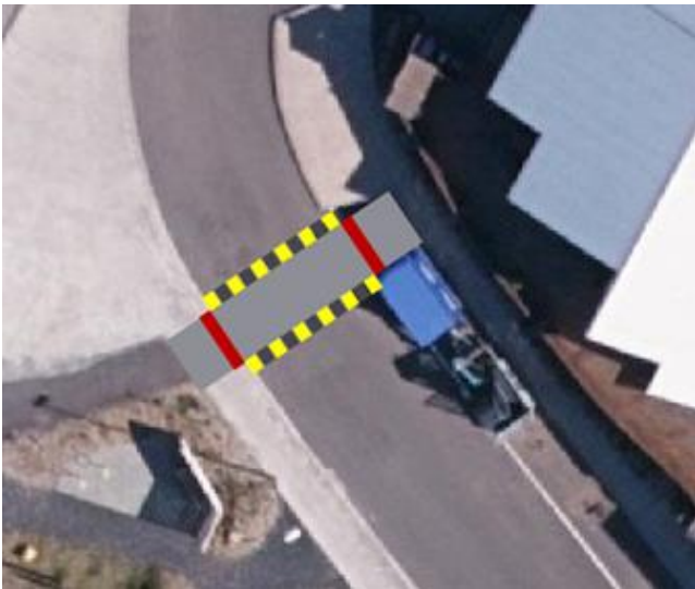
MYND 8 Tvær mögulegar útfærslur á gönguþverun við leikvöllinn með gúmmíhraðahindrunum. Hægri mynd sýnir lausn með svokölluðum fagureyjum.
