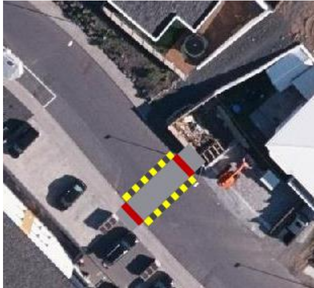
MYND 7 Einföld gangbraut með gúmmíhraðahindrun sitt hvorum megin við til að lækka umferðarhraða. Mynd vinstri: Fálkinn Ísmar.
