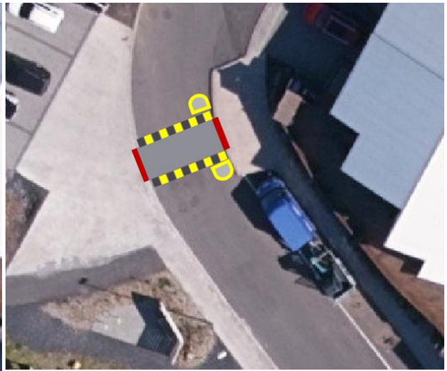
MYND 8 Tvær mögulegar útfærslur á gönguþverun við leikvöllinn með gúmmíhraðahindrunum. Hægri mynd sýnir lausn með svokölluðum fagureyjum.
